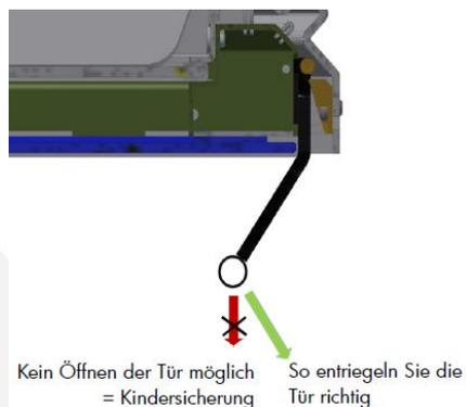
Der integrierte Schutzmechanismus an der Tür des Ortner Grundofens unterstützt die Sicherheit beim ungewünschten Öffnen der Tür (Kindersicherung). Mit der richtigen Hebelwirkung (grüner Pfeil) entriegelt der Schließmechanismus ganz einfach.
